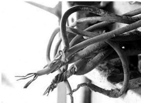
эксплуатируются оголенные или имеющие повреждения электрические провода, кабели (следы оплавления, трещины)
