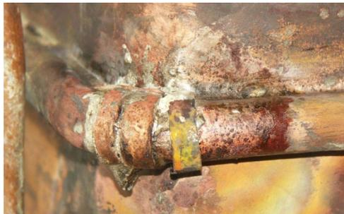
имеются следы сквозной коррозии, механические повреждения газового оборудования
