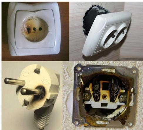
допускается эксплуатация выключателей и розеток, в том числе на удлинителях, без корпусов, корпуса имеют повреждения (оплавлены, расколоты)
