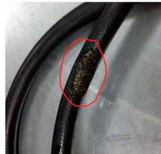
имеются механические повреждения присоединительного гибкого шланга (перегибы, порезы, сквозные трещины и (или) протертости)
